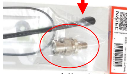
BNC→SMA変換コネクタ
